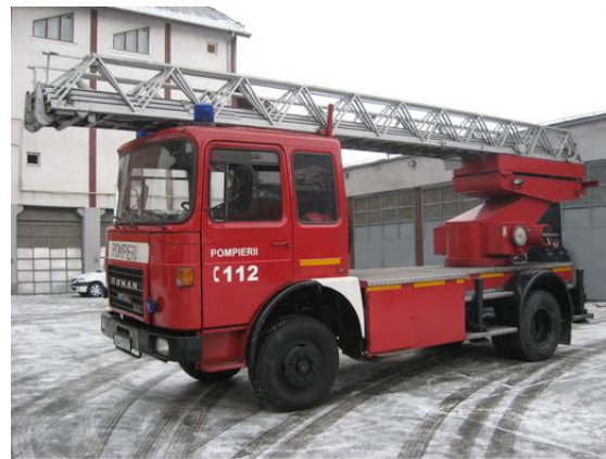
Autoscară mecanică de 30 m
