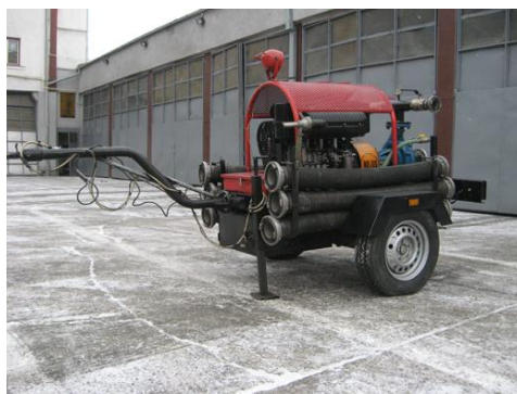
Figura 9.26 Utilaj de stingere a incendiilor: motopompă remorcabilă (site ISU-Sibiu)
